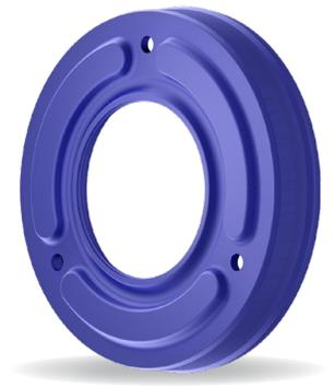
Die Dämpfungsdichtung D&S 300 ist eine patentierte Dämpfungsdichtung für den Zylinderdeckel, die mehrere Funktionen gleichzeitig erfüllt. Sie dichtet statisch zum Zylinderdeckel ab, dämpft mechanisch in der Endlage den Kolbenhub und dämpft pneumatisch durch Luftdrosselung.
